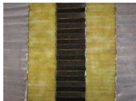
Øverst: Et stykke klippet ud af filterelementet. De enkelte lag i filterelementet. Til venstre: Store partikler på det yderste trådnet. Nedenfor: Slidpartikler på den grove filterdug. Nederst: Slidpartikler på den fine filterdug.
