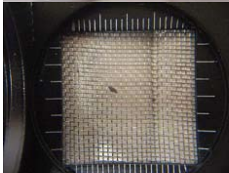
Øverst: Et stykke klippet ud af filterelementet. De enkelte lag i filterelementet. Til venstre: Store partikler på det yderste trådnet. Nedenfor: Slidpartikler på den grove filterdug. Nederst: Slidpartikler på den fine filterdug.
